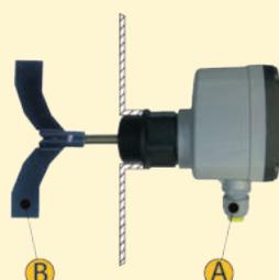
A: Quando la RL-A viene montata lateralmente, assicurarsi che il pressacavo sia posizionato verso il basso per evitare infiltrazioni di acqua all'interno della stessa, questo si ottiene ruotando la custodia contro il proprio attacco filettato. In order to avoid water infiltration in the housing when the RL-A is side fixed, make sure that the cable gland faces downwards by rotating the housing on the thread.
