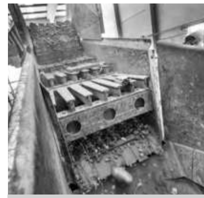
Vorabscheider mit Unwuchterreger zur Aufbereitung von Bauschutt Grizzly feeder with unbalanced exciter for processing construction waste
