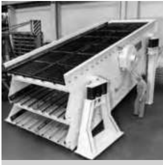
Dreidecksieb mit Unwuchtmotoren für Kieswerk Three-deck screen with unbalanced motors for a quarry
