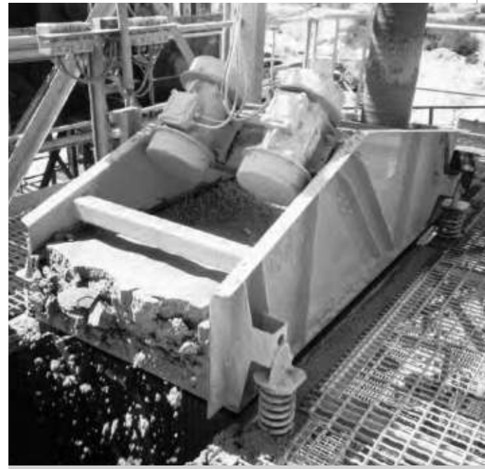
Entwässerungssieb mit Unwuchtmotoren in der Kiesindustrie Dewatering screen with unbalanced motors for sand and gravel
