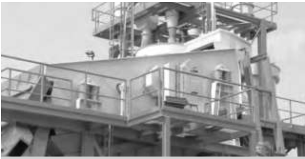
Doppeldeck-Kreisschwingsieb für gebrochenes Steinmaterial Double-deck circular vibratory screen for crushed stone
