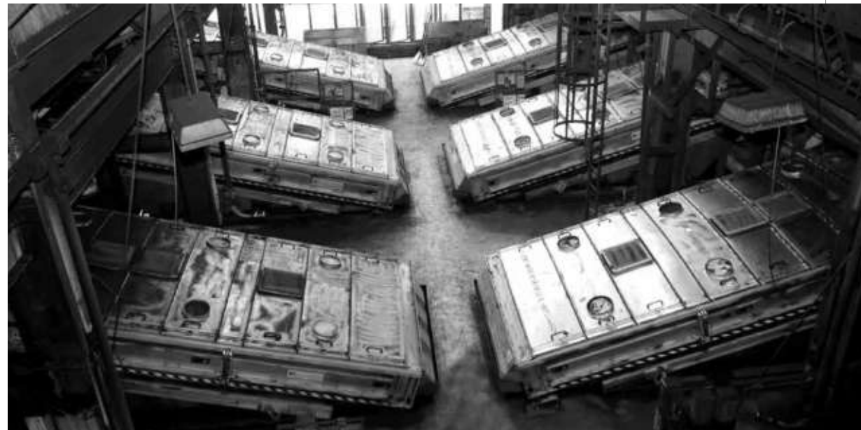
Eindeck-Spannwellensieb in der Kohleaufbereitung Single-deck Flip-flop screening machine in coal preparation
