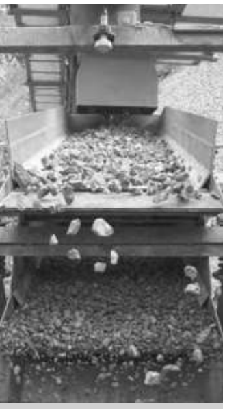
Doppeldeck-Kreisschwingsieb für gebrochenes Steinmaterial Double-deck circular vibratory screen for crushed stone
