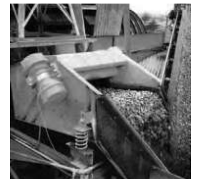
Entwässerungssieb mit Unwuchtmotoren in der Kiesindustrie Dewatering screens with unbalanced motors for sand and gravel
