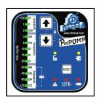
打开泵电源后,用上下键选择所需要的润滑循环模式 有 12 个循环时间模式可供选择
